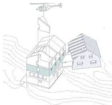
Montage des étages supérieurs
